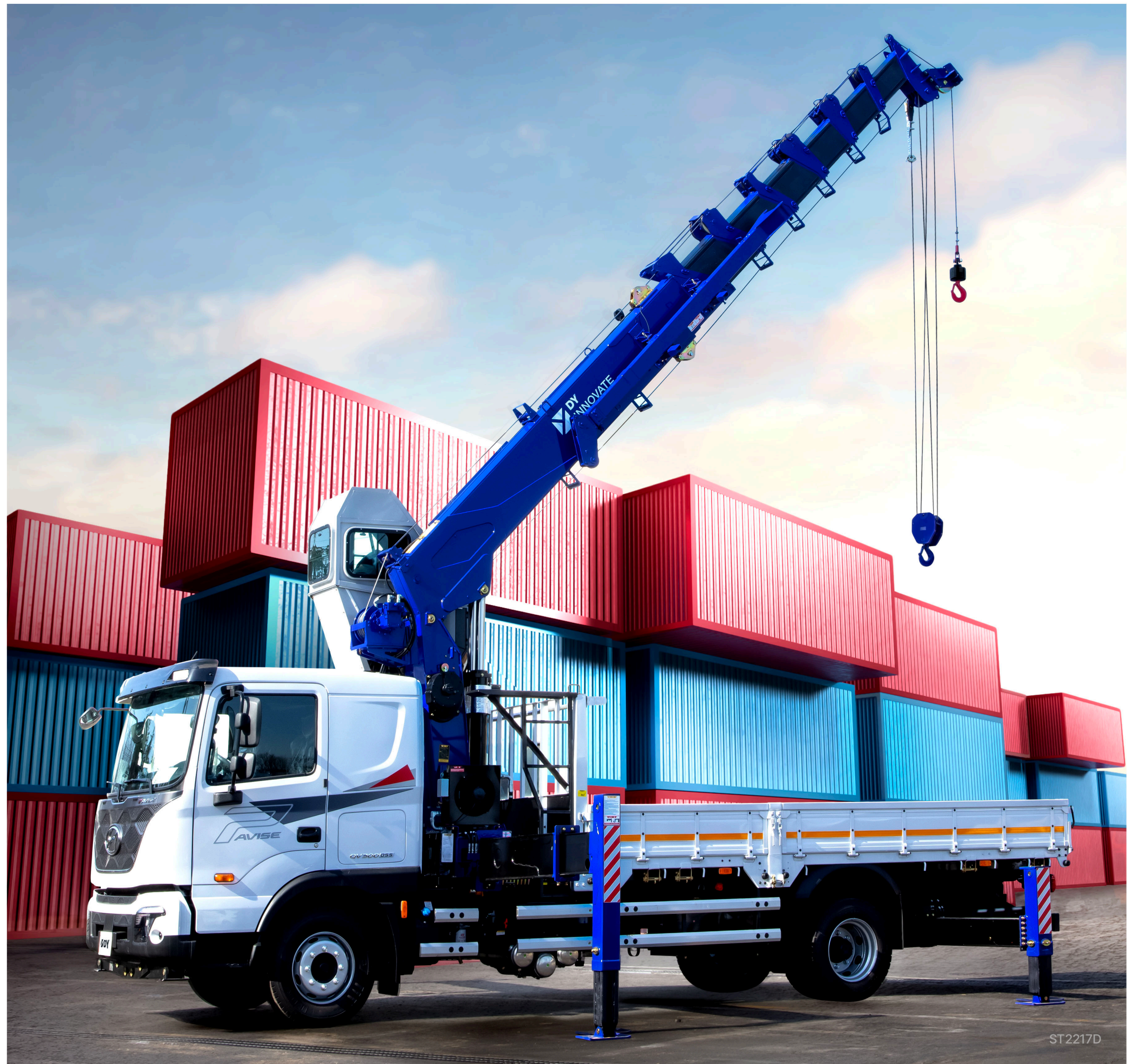
③ 동급최대 아우트리거 크레인 흔들림을 최소화하여 작업의 안전성과 내구성을 극대화 하였습니다(사이드 확장 5M)
