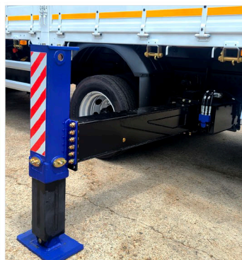
③ 동급최대 아우트리거 크레인 흔들림을 최소화하여 작업의 안전성과 내구성을 극대화 하였습니다(사이드 확장 5M)
